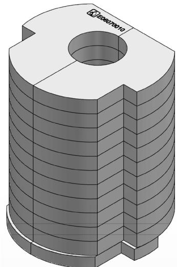
Поэтому печь обеспечивает обогрев за счет излучения, проводимости, а также натуральной или принудительной конвекции (с системой Multifuoco), при наличии пламени. При выключении система HSS продолжает излучать тепло натуральным образом, поддерживая накопительную массу при соответствующей температуре еще в течение нескольких часов.
