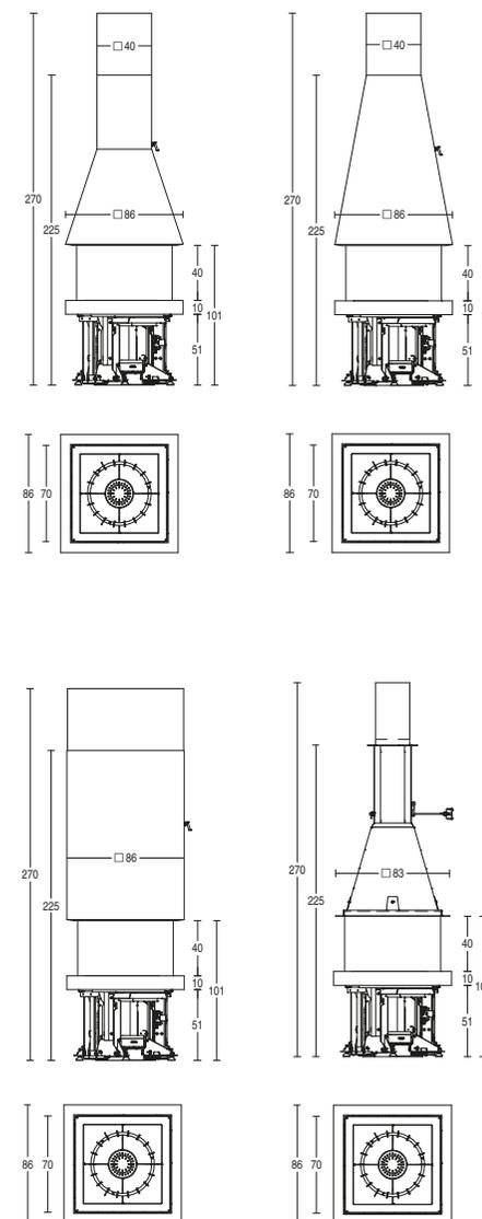
La dimensione di 2,70 m indicata nei disegni tecnici si riferisce alla misura a listino. L'altezza minima necessaria per l'installazione è di 2,50 m. Tubo, supporto e copritubo possono essere forniti per altezze superiori su progetto personalizzato.
