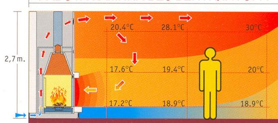
Диаграмма (слева) показывает распределение температур, зафиксированное в реальных комнатах с объёмом 250 куб м с традиционной системой отопления.
