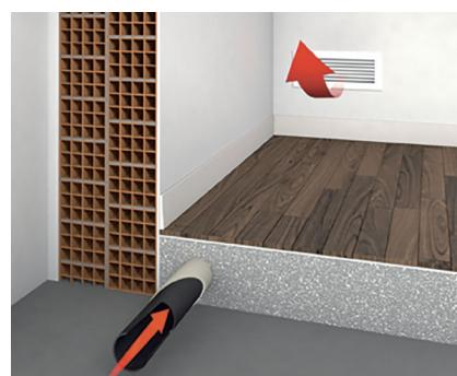
**Эксклюзивная система распределения тепла по помещениям на уровне пола имеет очевидные преимущества: равномерное распределение тепла от пола до потолка, подача воздуха в смежные комнаты.**
